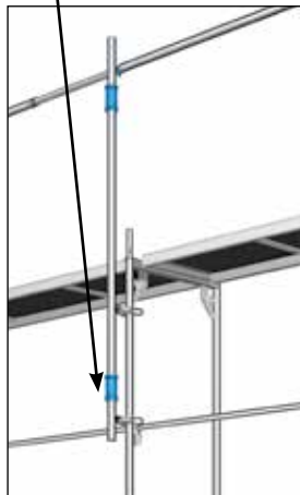
Rys. 21 i 22: Montaż słupka poręczy wyprzedzającej ramy rusztowania Blitz
