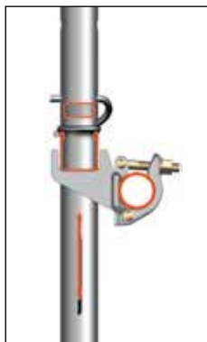
Rys. 52: Przekrój przez złącze węłowe
