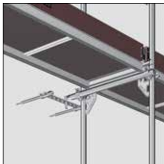
Rys. 57: Kotwienie z użyciem systemu WDVS
