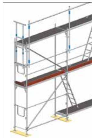
Rys. 23: Montaż poręczy wyprzedzającej czołowej
