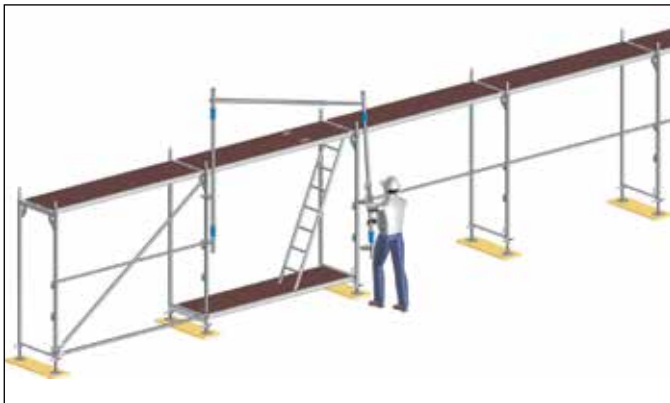
Rys. 25: Montaż poręczy wyprzedzającej w polu komunikacyjnym
