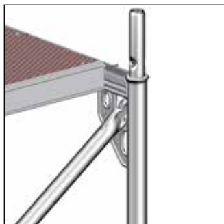
Rys. 28: Stężenie pionowe - górna część
