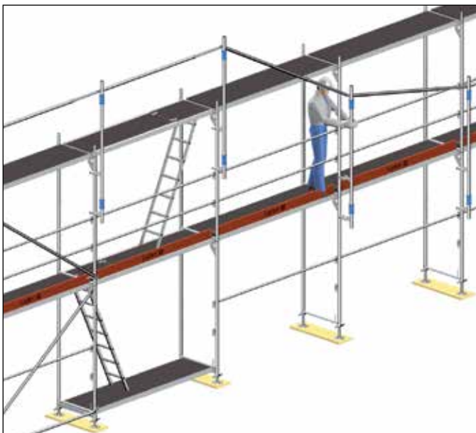
Rys. 26: Prezentacja użycia poręczy wyprzedzającej na poziomie rusztowania
