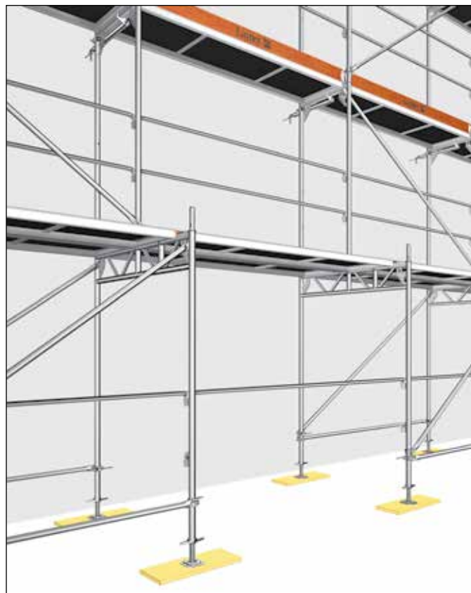
Rys. 105: Montaż ram przejściowych
