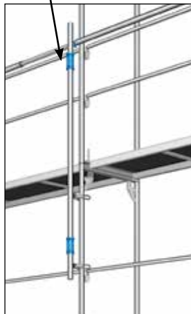
Rys. 21 i 22: Montaż słupka poręczy wyprzedzającej ramy rusztowania Blitz
